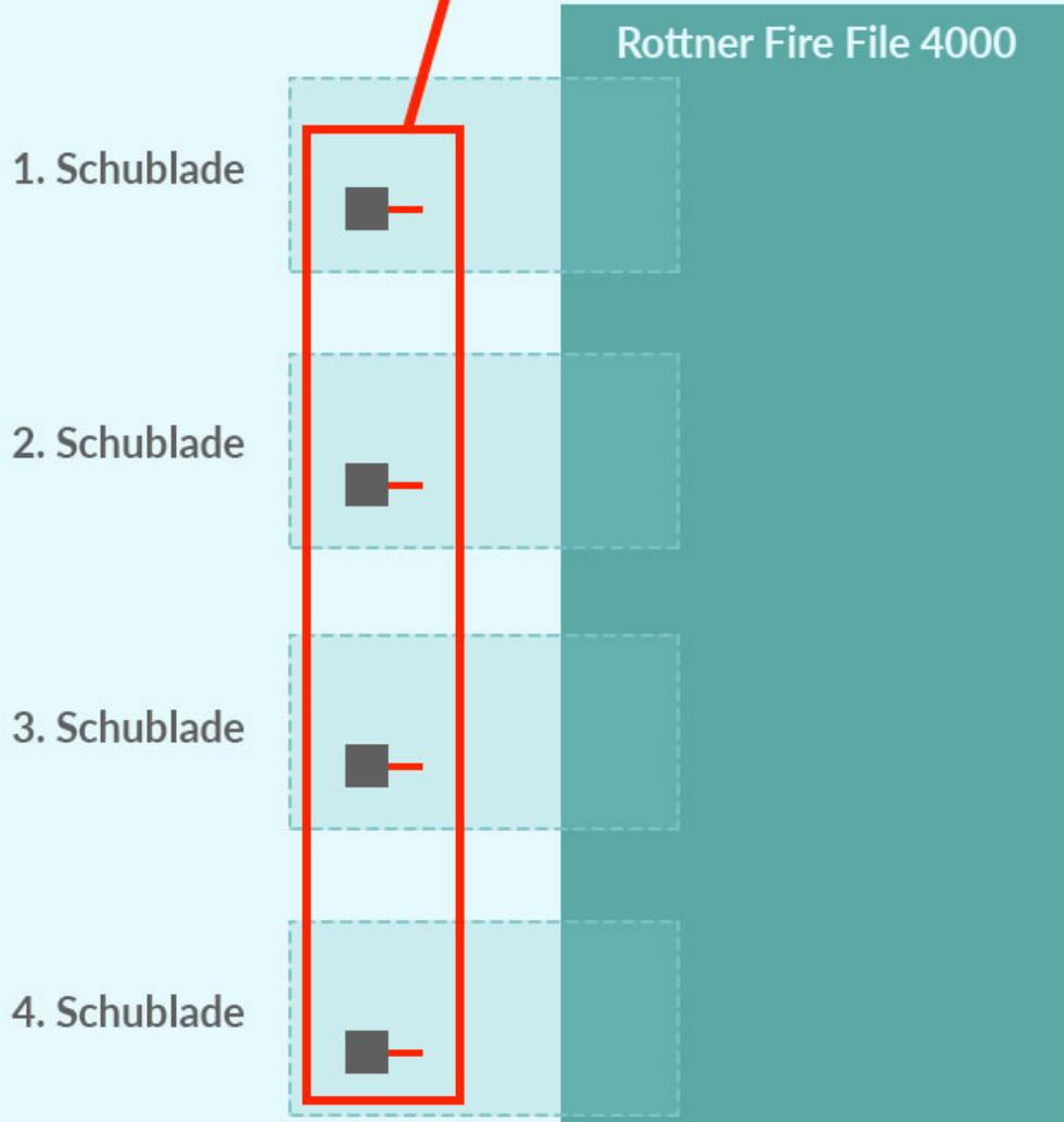
Sperrriegel in vertikaler Position --> Schublade ist offen, auch wenn das Zylinderschloss versperrt ist.
