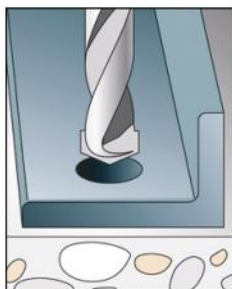
1. Bohrposition markieren und bohren (Ø 12 mm)
